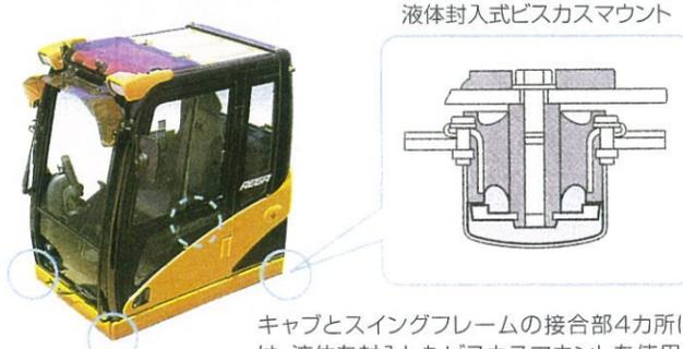
キャブとスイングフレームの接合部4カ所には、液体を封入したビスカスマウントを使用。機体からの振動や騒音をシャットアウトしてオペレータの疲労を抑えます。
