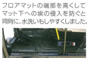
フロアマットの端部を高くしてマット下への埃の侵入を防ぐと同時に、水洗いもしやすくしました。
