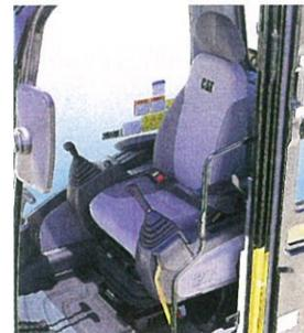
ライト&ダークグレーのツートンカラーと落ち着いた色調の新型エアサスペンションシートを標準装備。クッション硬さや体重調節などオペレータに最適なシートアレンジが可能です。また、静電気帯電防止加工により、静電気による不快感を払拭しました。
