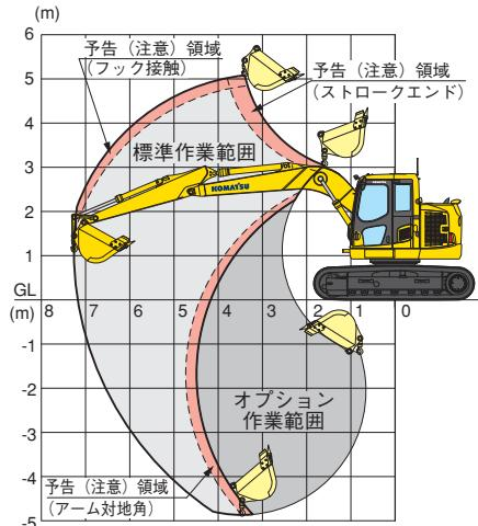
※アームシリンダボトム側落下防止弁（オプション）装着により
